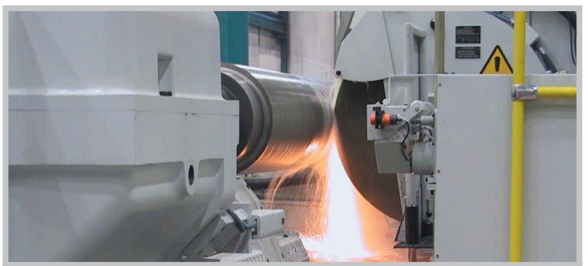
Schruppschleifen mit 1.200 Ampere
